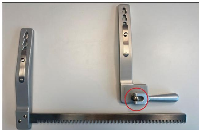
2. Stecken Sie den rechten Arm mit dem Drehhebel auf die Zahnstange auf und drehen diese nach links ein.
